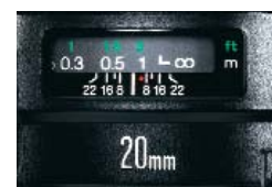
Photo 1 Condition de définition de la distance hyperfocale
