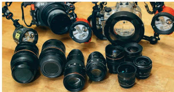
Pour la photographie sous-marine, le boîtier étanche est essentiel. Des ports dôme (pour les objectifs grand angle) et macro (pour les objectifs macro) sont disponibles selon l'objectif utilisé.
