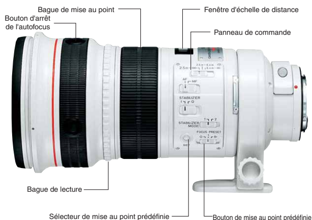
Photo 20 Unité de fonctionnement de la mise au point prédéfinie de l'EF 300 mm f/2,8L IS USM
